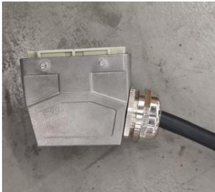
图 3-4 电机电源线缆接头
