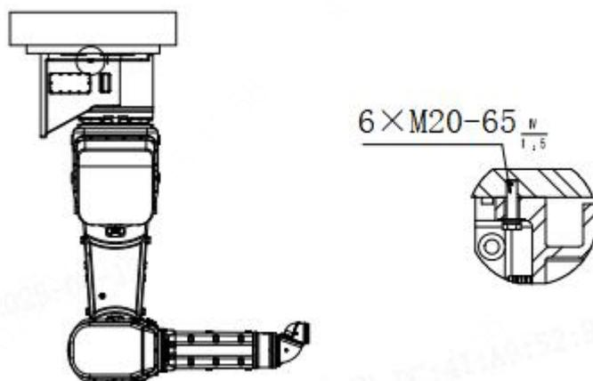
图 3-6 倒挂安装
