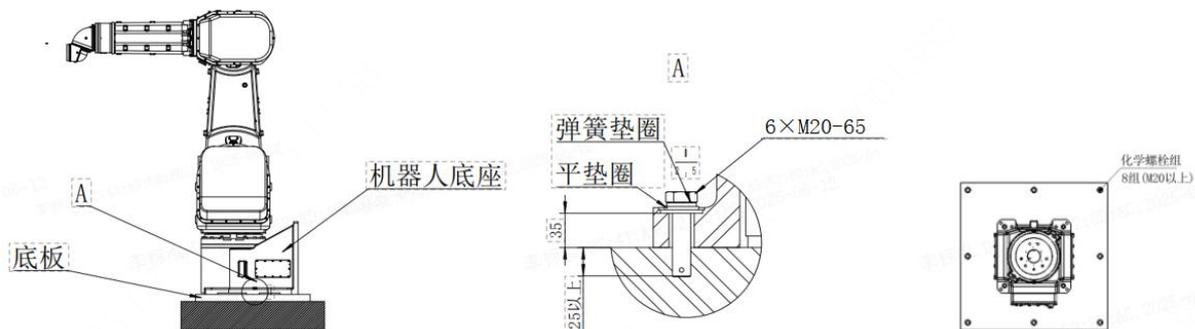
图 3-4 机器人安装举例
