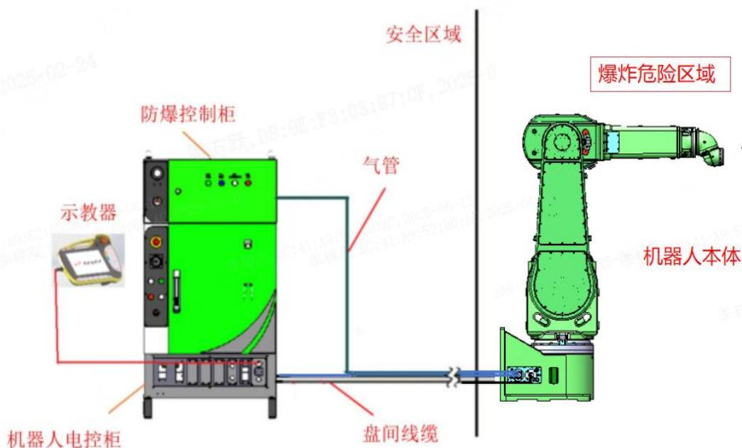
图 2-1 工业机器人系统构成
