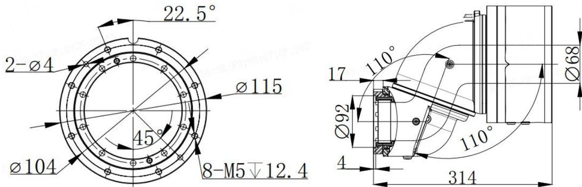
图 3-7 末端负载安装法兰尺寸
