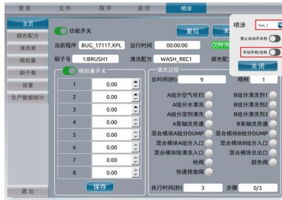
开启“手动开枪/关枪”开关，“GUN MAN”指示灯亮，如果配置了枪阀的 IO 就会触发相应数字量 IO 输出信号。
