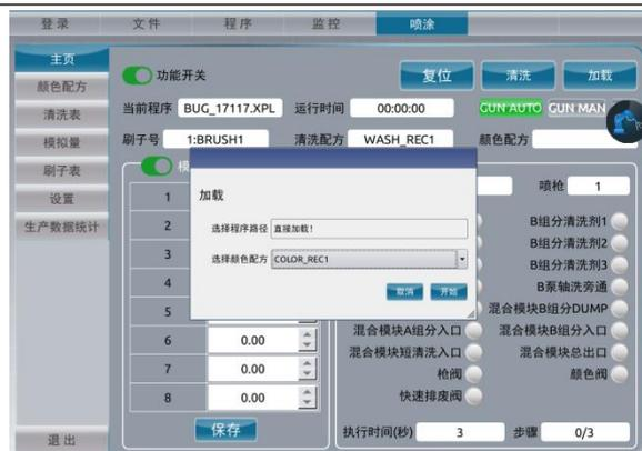
点击“加载”按钮，进行手动颜色加载，也有两种方式。操作逻辑与手动清洗相同，此处不再重复介绍，其中手动加载指令是 `paint.manualLoad()`。
