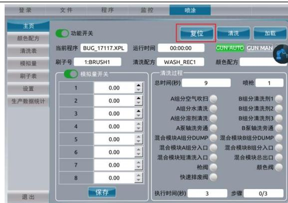
在清洗流程或者颜色加载流程执行过程中，点击“复位”按钮，清洗或加载工艺流程步骤终止并复位相关阀的状态。
