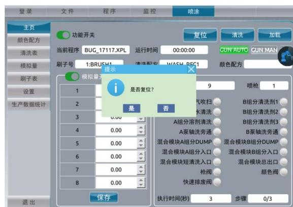
点击“清洗”按钮，进行手动清洗，手动清洗有两种使用方式。
