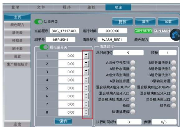
图中 1-8 分别对应刷子表中的通道值，其中 1/2/3 系统预定义为模拟量中的流量/雾化/扇形。
