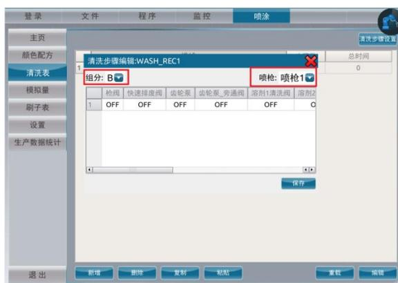
修改步骤完成后，点击“编辑”按钮，进入编辑状态，弹出清洗配方具体编辑子界面，可以设置每个步骤的清洗持续时间，以及各阀是否清洗，点击“保存”按钮，保存步骤和清洗数据并退出编辑状态，点击“取消”，退出编辑。
