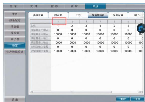
点击参数框，弹出数字键盘，修改参数并保存后，在刷子表中编辑时，弹出键盘的输入限制与此处设置的“输出量程”参数相同。
