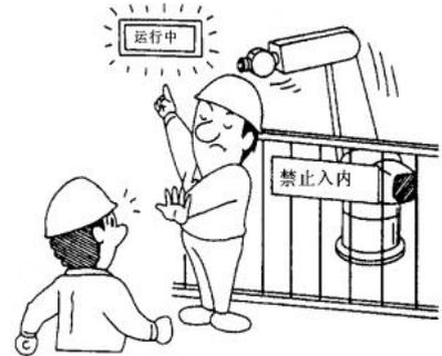
4、当需要示教/检查机器人，而进入安全围栏时，操作人员必须将安全插随身带在身上进入，以免有人意外操作机器人。同时，请在控制器前指派一个监察员，用于监控各操作，并能随时按紧急停止按钮。监察员也必须是完成了特别培训课程的员工。
