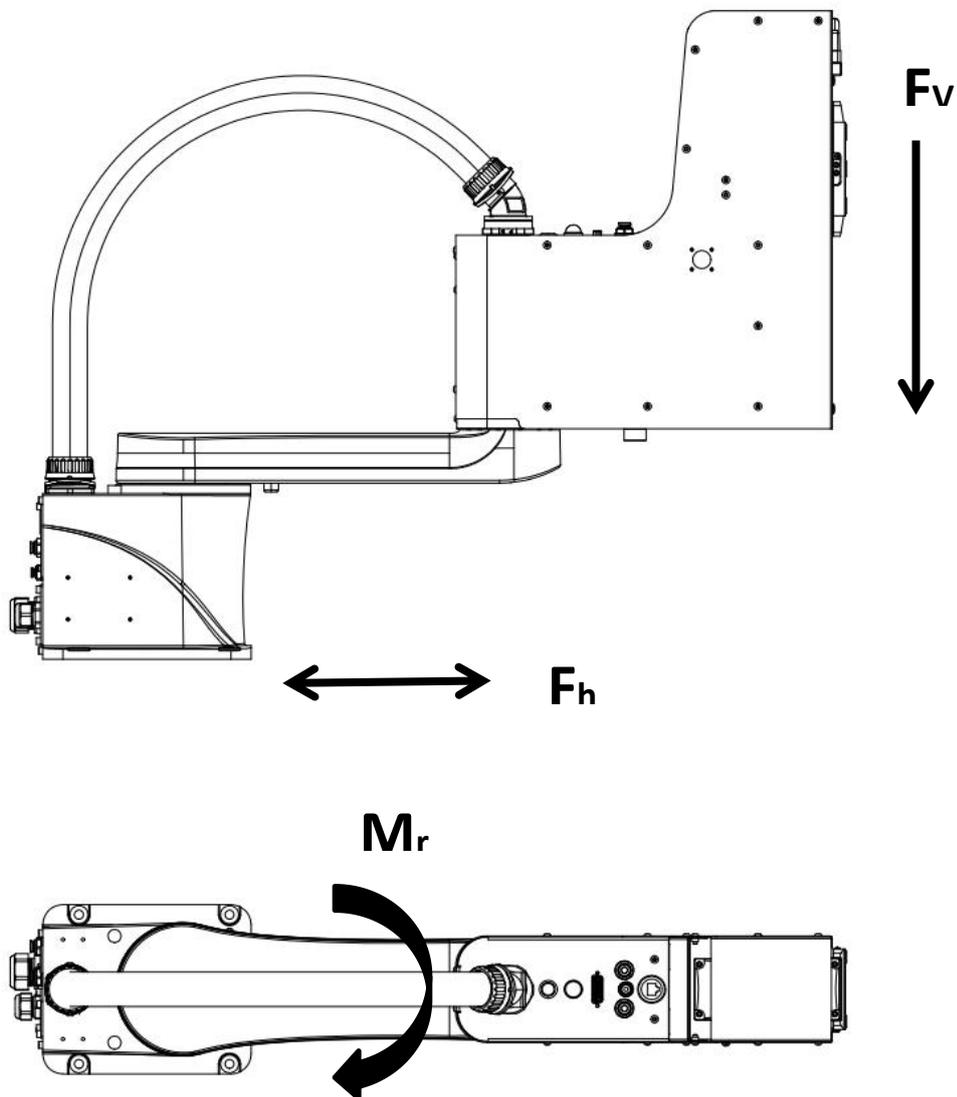
图 3-7 机器人底座受力示意图
