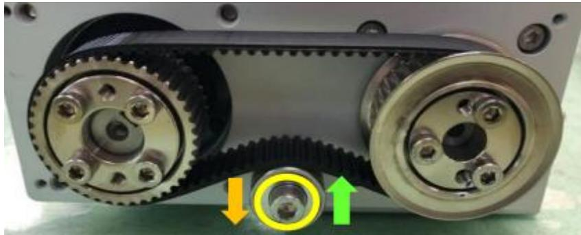
图 4-2 同步带传动机构示意图
