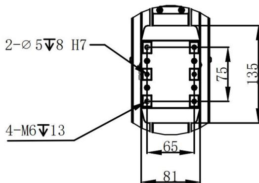
图 3-6 工具安装接口尺寸
