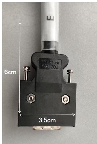
图 3-4 电机信号线缆接头
