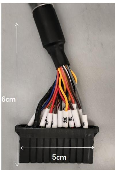
图 3-3 电机电源线缆接头
