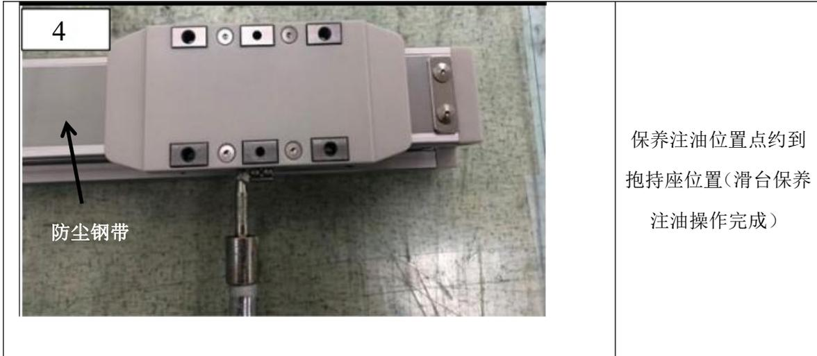
注：滑台模组防尘钢带定期清洁维护，如出现过度拉长变形，损坏等情况，请及时联系厂家更换
