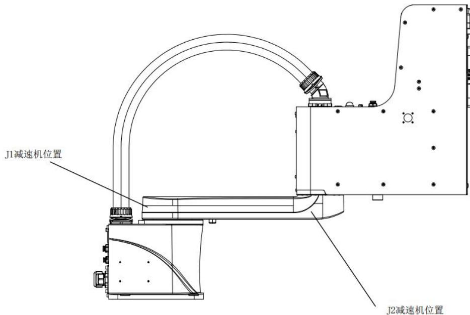
图 4-1 谐波减速机位置示意图
