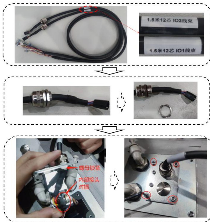
图 3-15 I0 接头安装示意图
