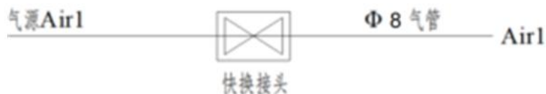
图 3-10 焊接气路原理图（标准）
