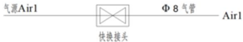
图 3-11 焊接气路原理图（标准）
