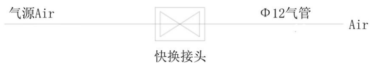
图 3-15 标准型气路原理图（标准）
