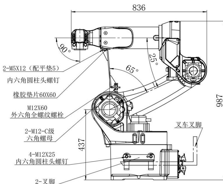
图 3-1 打包固定支架安装示意图
