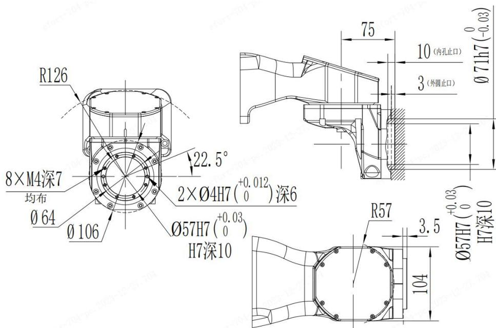
图 3-7 末端负载安装法兰尺寸
