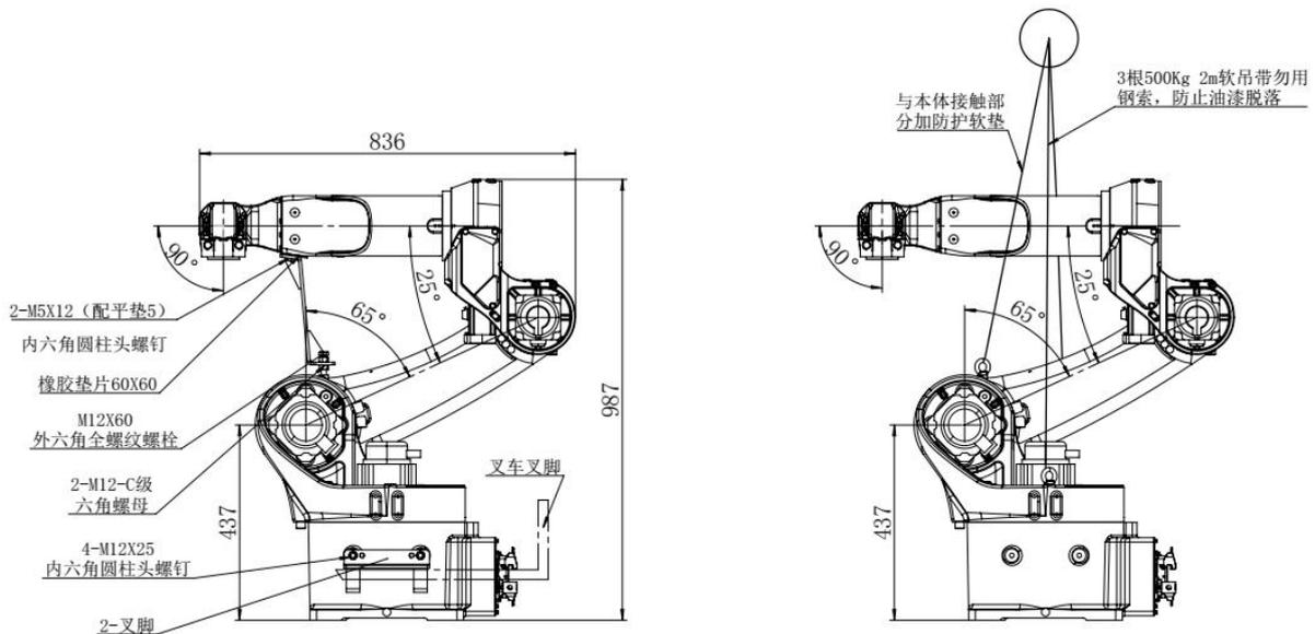
图 3-3 转运示意图（左侧叉车转运、右侧行车吊装）
