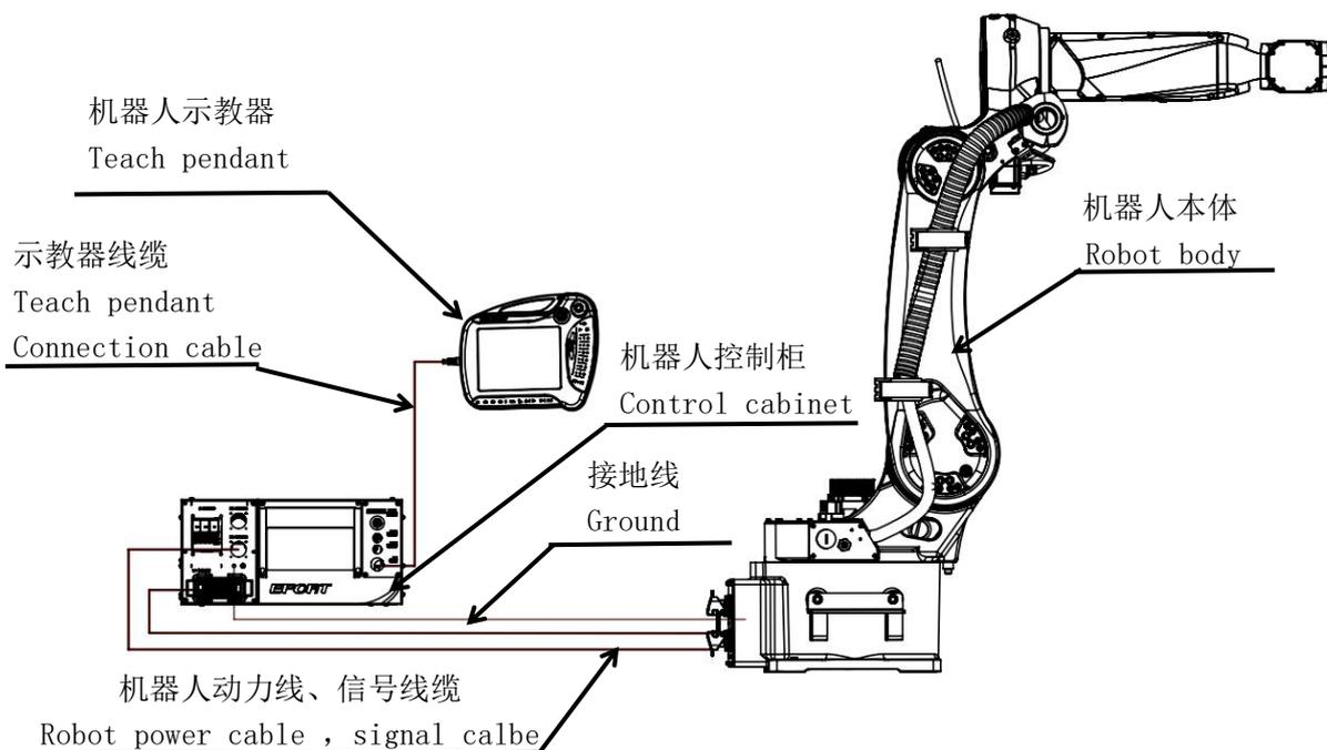
图 2-1 工业机器人系统构成
