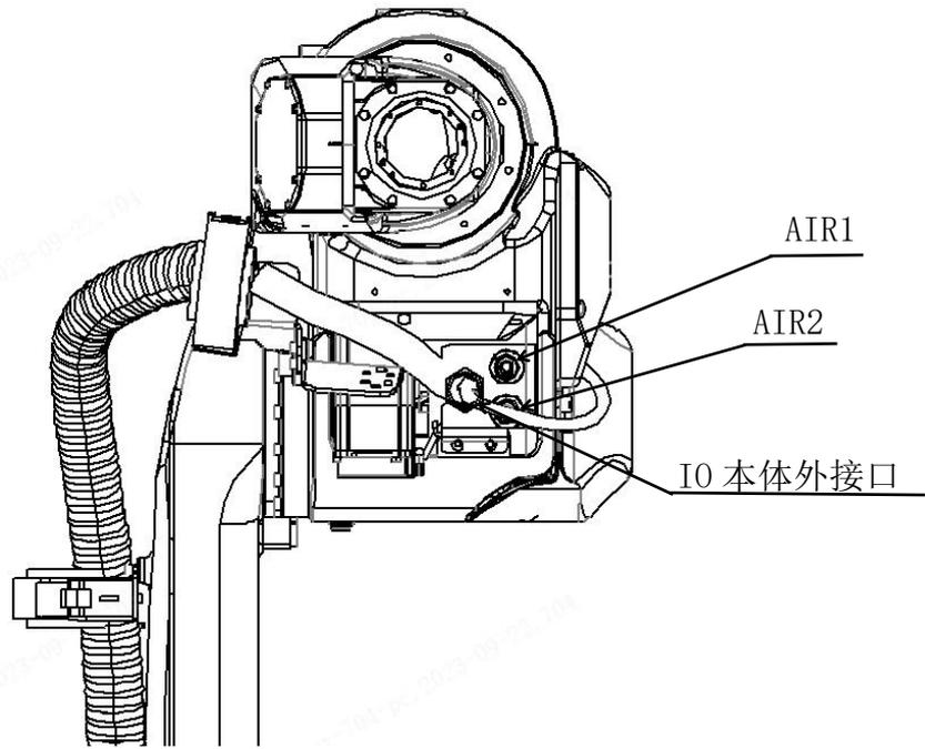
图 3-11 电机座部分气路及信号线接口
