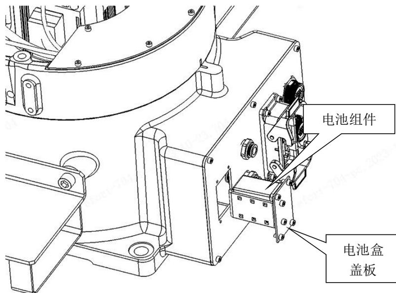
图 4-4 机器人电池组位置图
