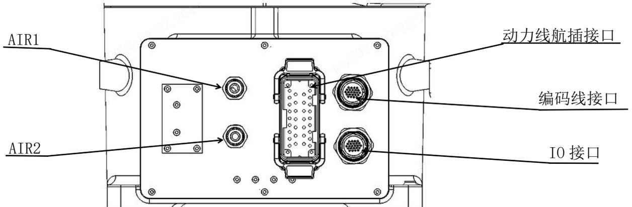
图 3-10 底座部分气路及信号线接口
