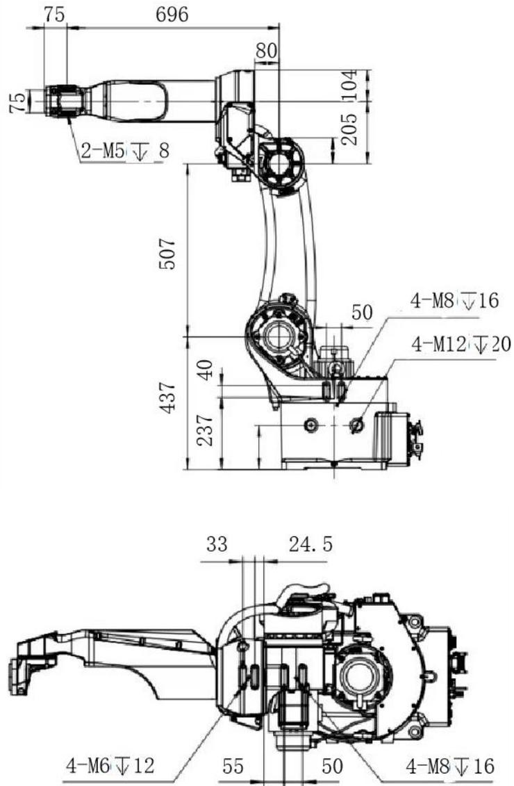
图 3-8 外围安装尺寸图
