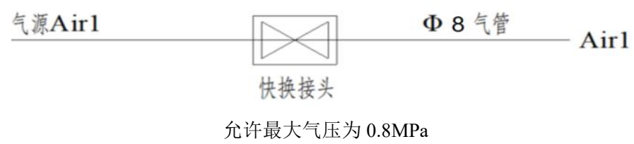
图 3-15 外接气管和信号线规格
