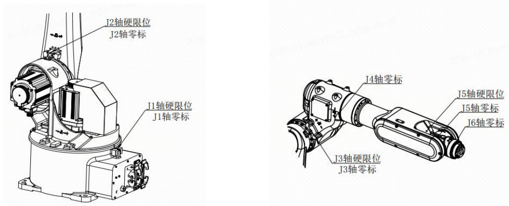
图 2-4 机械硬限位位置及零标位置
