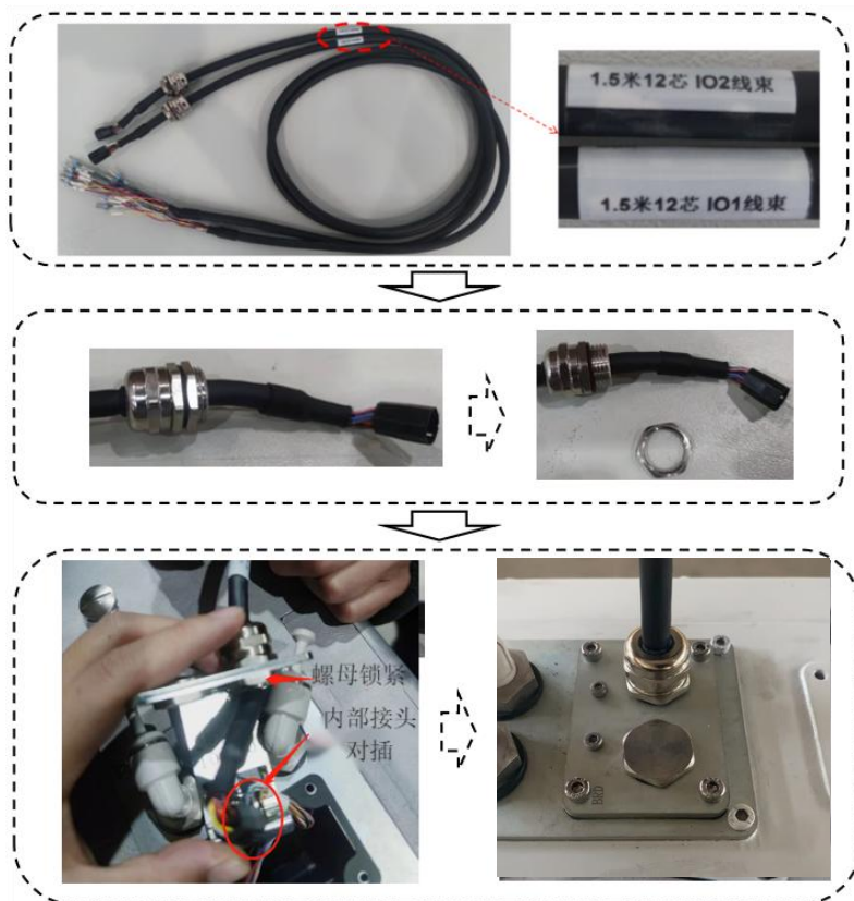
图 3-18 IO 锁头安装示意图
