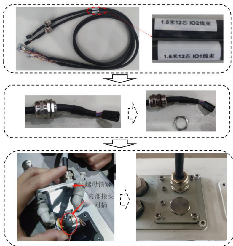
图 3-15 IO 锁头安装示意图
