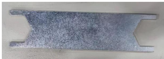
a. 小臂 IO 信号线安装扳手
