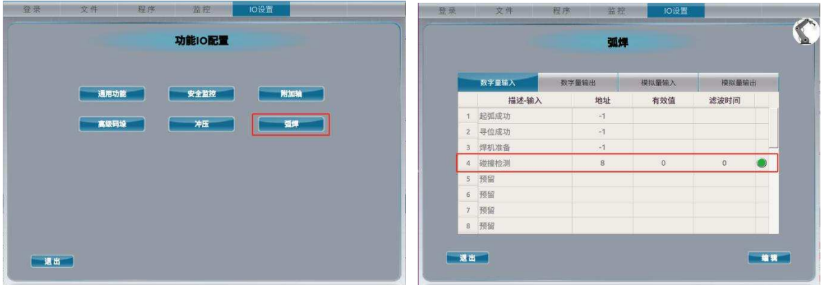
图 2-21 防碰撞信号配置(示教器界面)
