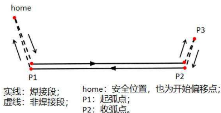
图 3-34 单道直线往复多层多道焊示意图
