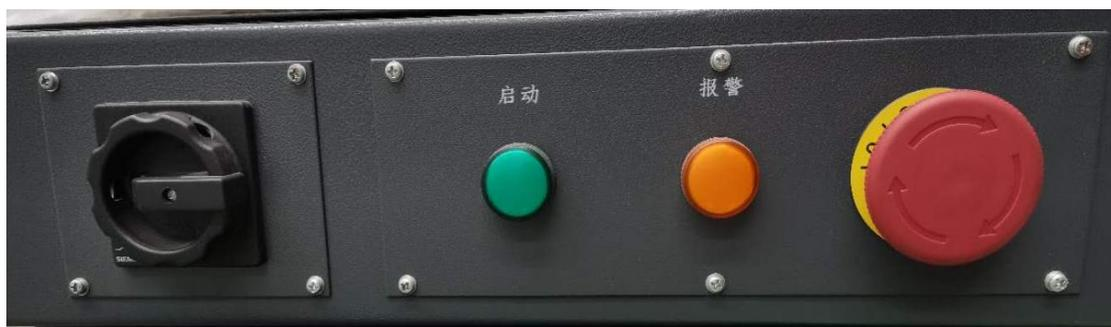
图 3-22 电柜前面板按钮布局图
