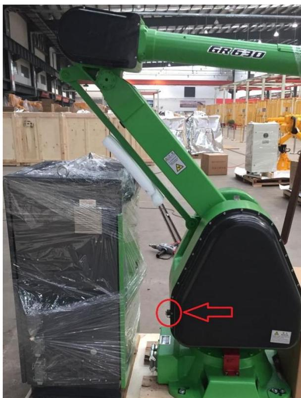
图 3-32 有线拖动示教手柄信号接收模块预留接口
