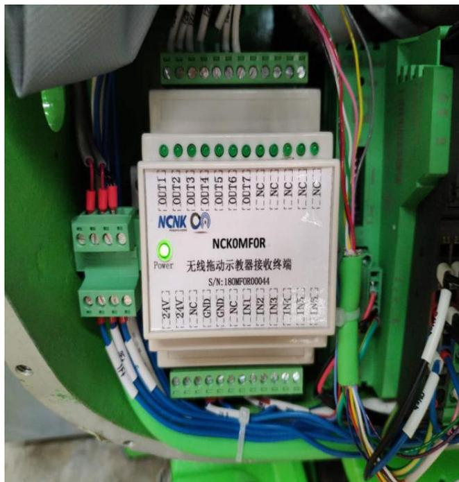
图 3-31 拖动示教手柄信号接收模块实物图
