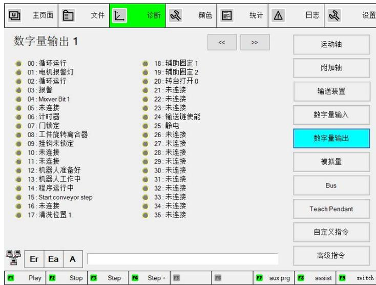
在示教器诊断界面, 打开数字量输入监控界面, 其中 00-11 对应模块 X20D09322, 12-17 对应第一个 X20D06529 模块, 18-23 对应第二个 X20D06529 模块, 24-25 对应 X20D02649 模块。
