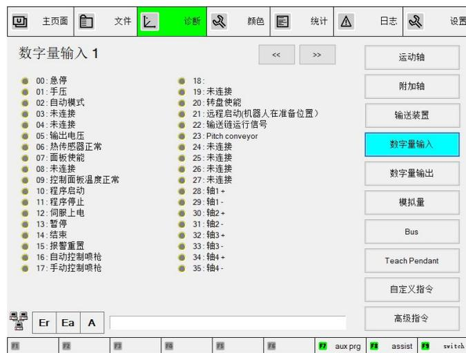
在示教器诊断界面，打开数字量输入监控界面，其中 00-15 对应模块 X20DIF371，16-27 对应模块 X20DI9371。
