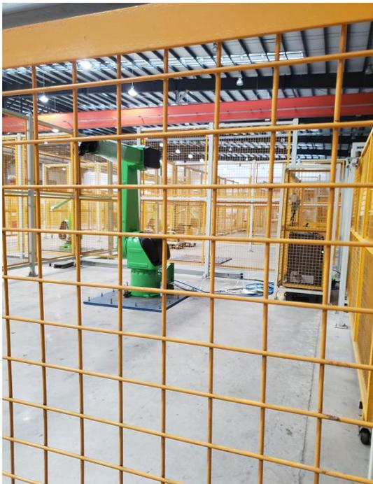
图 2-5：机器人保护围栏
