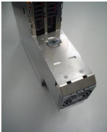
图 4-25 更换驱动器的散热风扇
