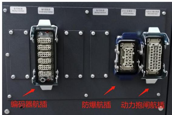
图 2-13 电控柜各航插定义
