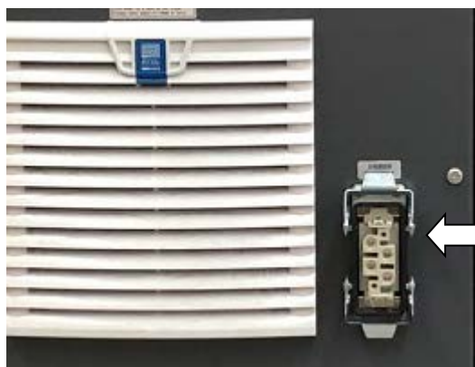
Figure 17:Connecting the Robot 连接机器人
