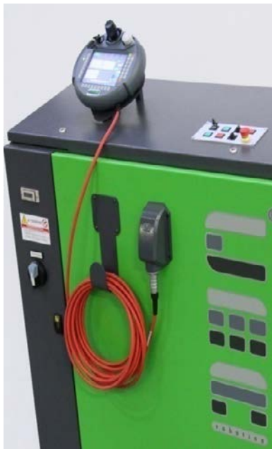
Figure100:Connecting the pendant 连接示教器
