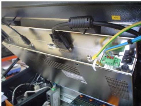
Figure30:Replacing the Display 更换显示器
