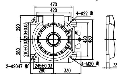
手腕及末端安装尺寸图
