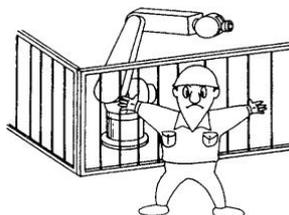
2. 围栏上的安全门应带有安全插销及其锁定机构，安全门必须通过拨开插销才能打开，并且拨开插销必须能导致机器人自动安全停止。
