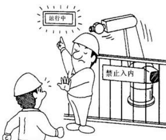
4. 需要示教/检查机器人进入安全围栏时，操作人员必须将安全插随身带在身上进入，以免有人意外操作机器人。同时，请在控制器前指派监察员用于监控各操作，并能随时按紧急停止按钮。监察员必须是已完成特别培训课程的员工。
