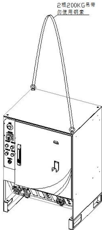
图 2-2 机器人控制柜吊装示意
