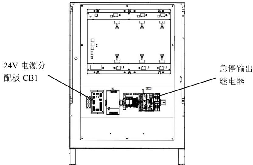
图 2-7 24V 电源分配板位置示意图
