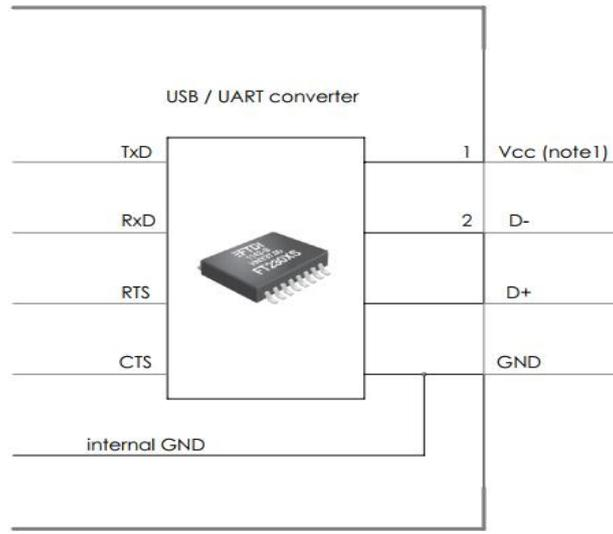
图 3-12 SER2 端口定义及连接电路图
