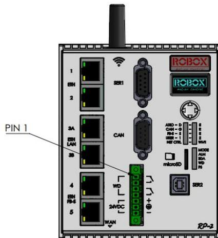
图 3-4 WD 端口位置指示图
