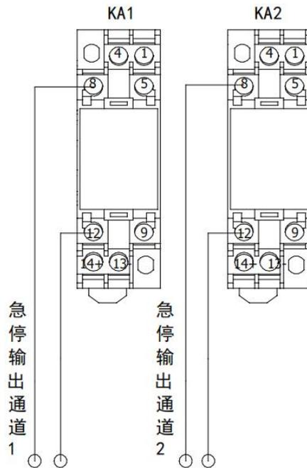
图 2-10 急停干触点端子
