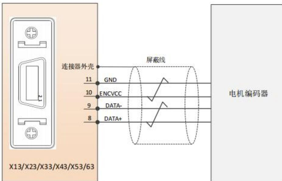
图 3-29 抱闸及编码器接线图示
