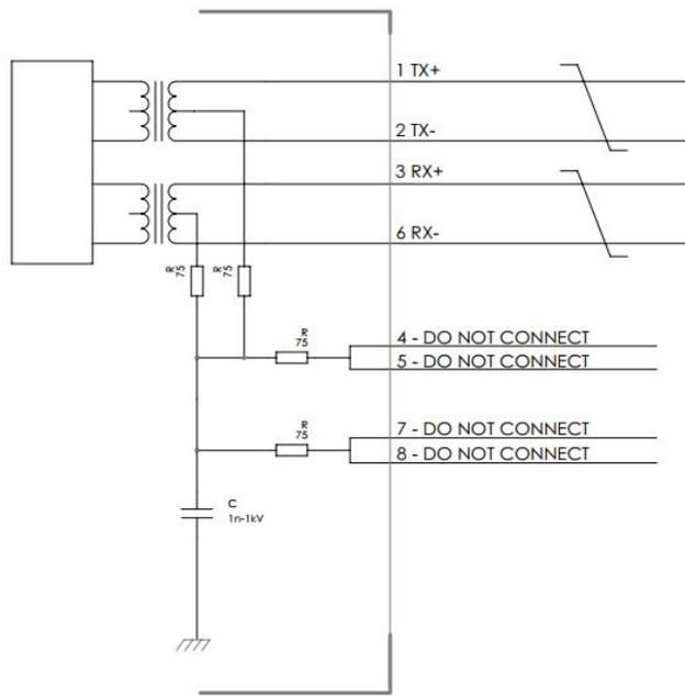
图 3-8 ETH 端口定义及连接电路图
