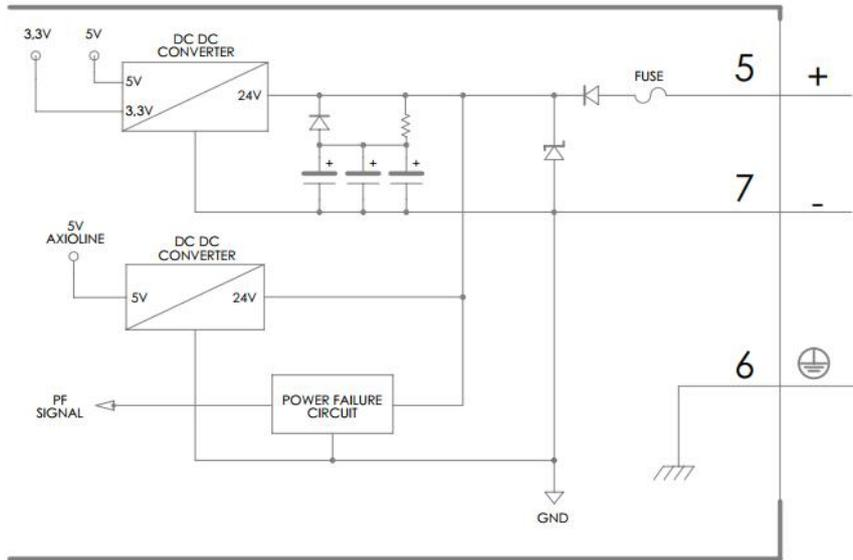
图 3-3 电源端口定义及连接电路图
