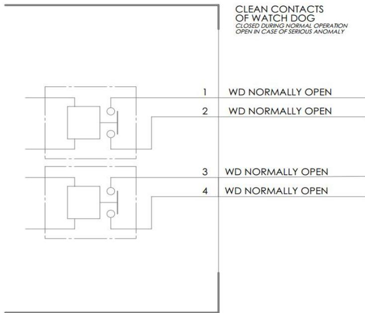
图 3-5 WD 端口定义及连接电路图
