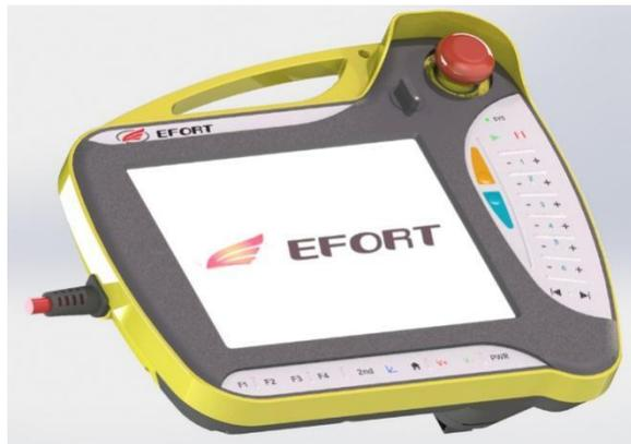
图 3-33 EFORT 示教器
