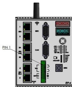
图 3-2 电源端口位置指示图
