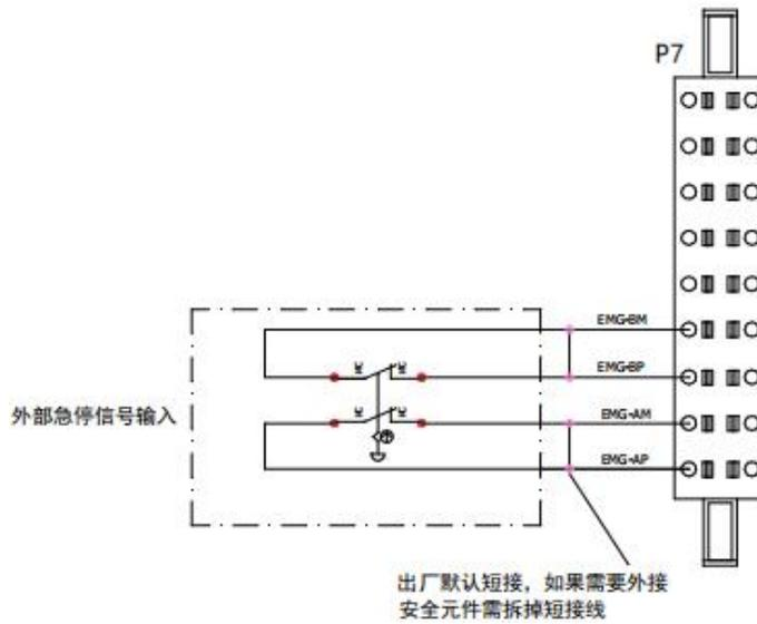
图 2-9 外部安全元件接线示意图
