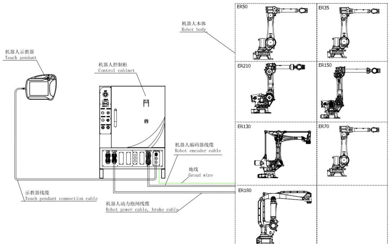
图 2-4 机器人线缆连接示意图
