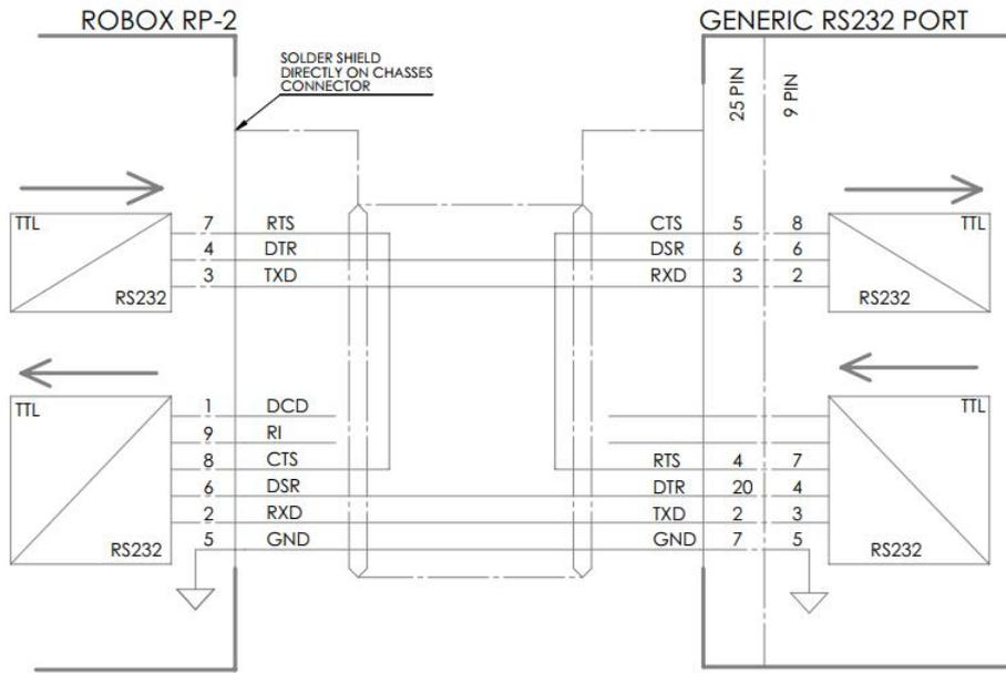
图 3-10 SER1 端口定义及连接电路图
