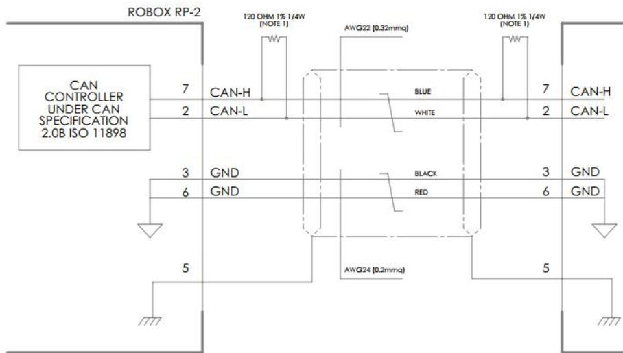
图 3-14 CAN 端口定义及连接电路图
