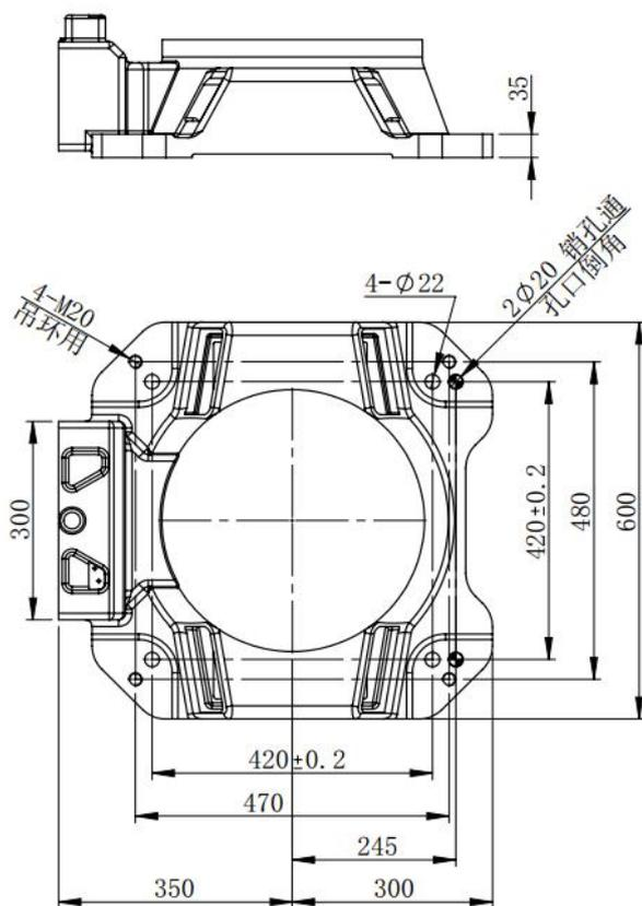
图 3-3 底座安装接口尺寸图
