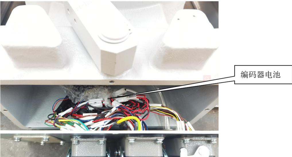
图 4-4 机器人电池组位置图
