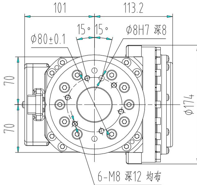
图 3-4 末端负载安装法兰尺寸 (一)
