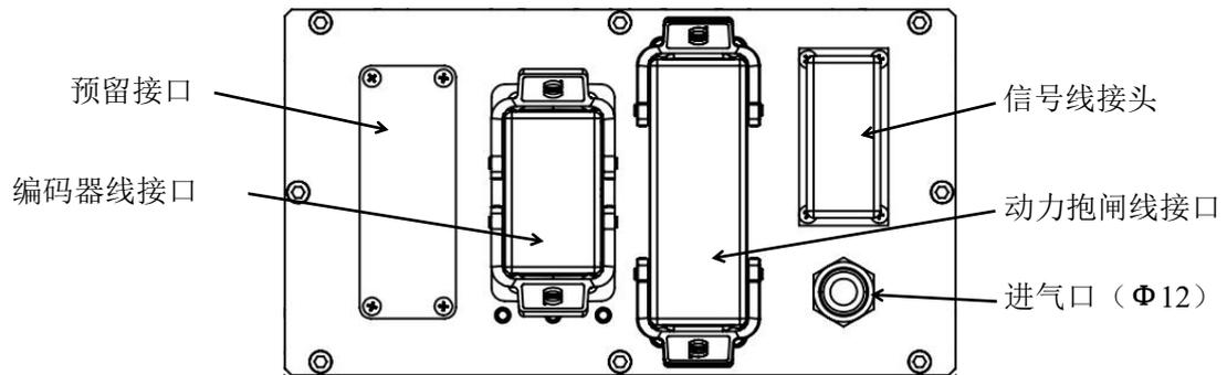
图 3-12 底座部分气路及信号线接口
