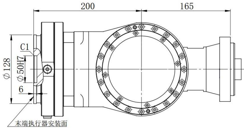
图 3-5 末端负载安装法兰尺寸 (二)
