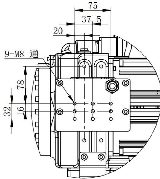
图 3-6 电机座上安装外部件尺寸图
