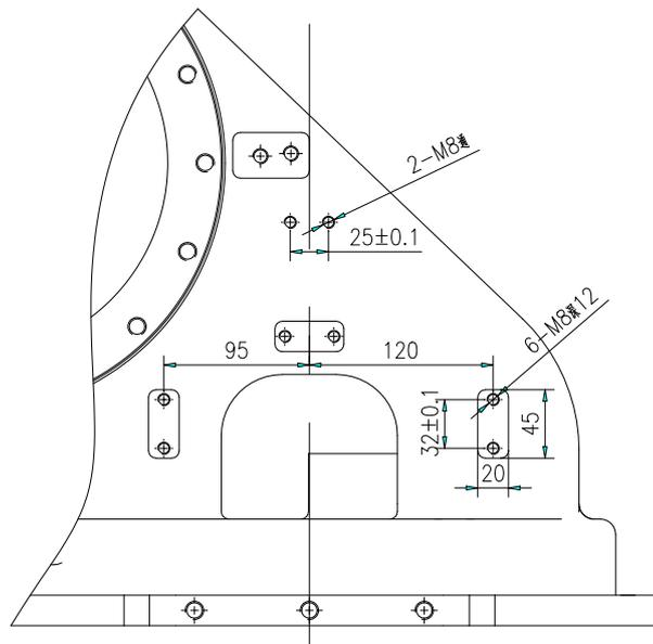
图 3-8 转座上安装外部件尺寸图
