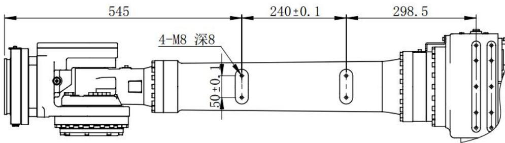
图 3-7 小臂杆上安装外部件尺寸图
