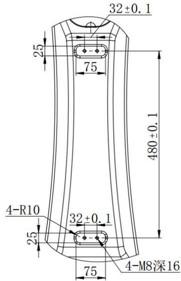
图 3-9 大臂上安装外部件尺寸图
