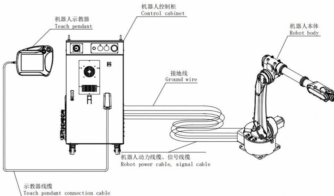
图 3-1 机器人线缆连接示意图
