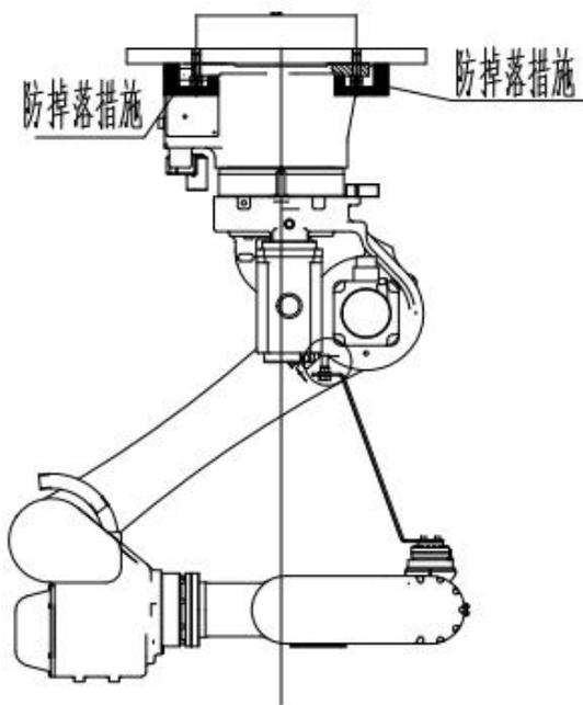
图 2-8 倒挂安装
