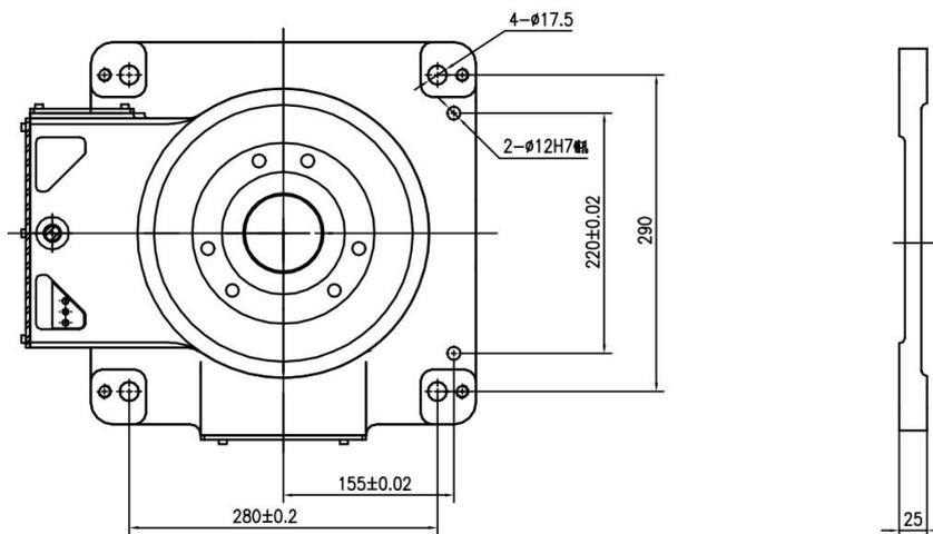
图 2-6 ER20-1700 机器人底座尺寸
