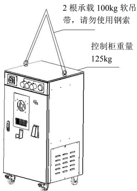
图 2-5 机器人控制柜吊装示意
