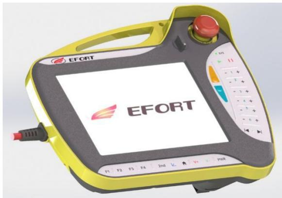
图 4-1 efort 示教器
