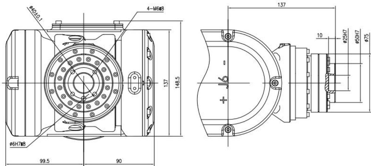
图 2-9 末端负载安装法兰尺寸
