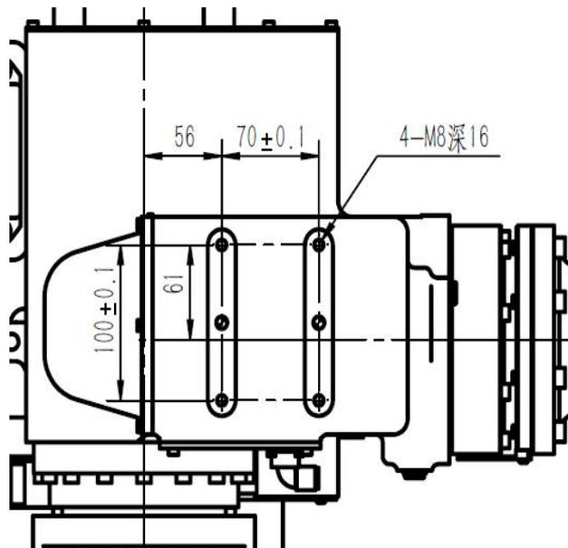
图 2-11 电机座上安装外部件尺寸图
