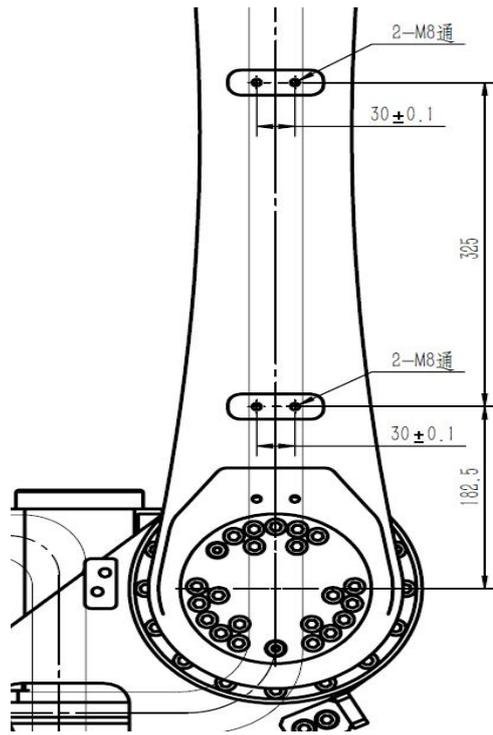
图 2-10 大臂上安装外部件尺寸图
